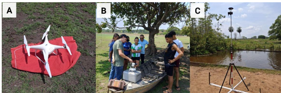
Figura 4 - A - Drone modelo DJI Phantom 4; B - voos participativos na comunidade; C - GNSS/RTK utilizado na correção planialtimétrica das imagens aéreas.
